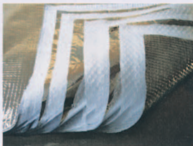
7 Die insgesamt 13-lagige Luftpolsterfolie Lu..po. Therm bietet neben dem Wärmeschutz auch abschirmende Wirkung. (Foto: LPS)
