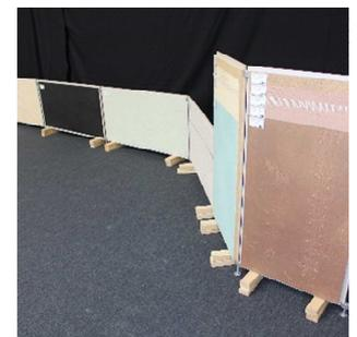
6. Dann werden die Stellfüße und oberen Verbinder der ersten vier Tafeln abmontiert und die frei gewordenen Aufbauschuhe für die Demontage der weiteren Tafeln eingesetzt (Staffelprinzip).
