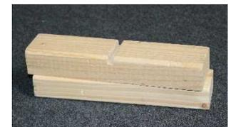
3. *Je zwei Paar werden benötigt, um eine Platte für das Verbinden zu fixieren. Platzieren Sie die Paare in einem Abstand von ca. 30 cm nebeneinander für eine vertikale Platte und in einem Abstand von ca. 60 cm für eine horizontale Platte.*
