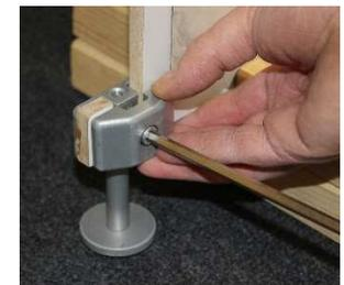
10. Nun wird die zweite Tafel mit der ersten verbunden (hier: 0.2 mit 0.4). Dazu platzieren Sie den nächsten Stellfuß mit dem entsprechenden GL-Verbindertyp zwischen den beiden Platten, schieben über die Aufbauschuhe die Tafeln auf Anschlag in die Aufnahme des Verbinders, achten wieder auf den unteren bündigen Abschluss und ziehen die Schraube an. Je nach Stellformation muss der Verbinder von der Sicht- oder der Rückseite des Messestands verschraubt werden.
