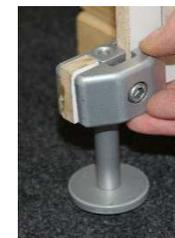
9. Prüfen Sie mit den Fingern der Hand, die den Verbinder hält, dass die Unterkante der Tafel bündig mit der Unterkante des Verbinders abschließt. Achten Sie auf geraden Sitz des Verbinders und ziehen Sie die Schraube von Hand moderat, aber mit festem und sicherem Sitz an. Der Stellfuß sitzt dabei nicht auf dem Boden auf!
