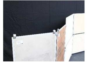
26. Tafeln 0.1 und 0.3 fixiert auf der unteren Reihe. Da diese Tafeln kein Putzmuster tragen und auch nicht mit einem Kopfschild versehen werden, befindet sich der obere Verbinder bündig mit der Oberkante der Tafeln.
