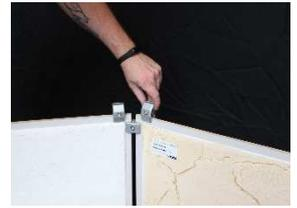
20. Stecken Sie die Tafel in die geöffneten Verbinder. ACHTUNG! Die Tafel wird in dem geöffneten Verbinder nicht von selbst halten, daher unbedingt zweite Person mit hinzuziehen.
