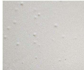
(Hinweis: Lehmdekorputze wie CAPRICCIO sind von ihrer Rezeptur hier so aufgebaut, dass während der Materialaufbereitung Luft eingebracht wird, um das Auftragen des Mörtels zu erleichtern; ein wesentliches Merkmal dabei ist, dass durch das Einebnen der aufgezahnten Putzschicht aufgrund der notwendigen Schichtstärke (zum besseren Einbetten der Effekte) im frischen Zustand kein Druck ausgeübt werden kann, um die Luft aus dem Mörtel zu pressen)
